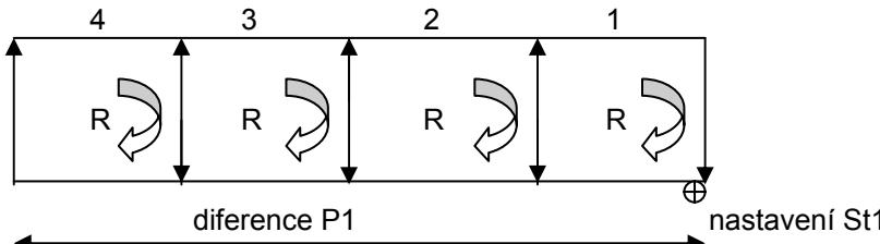
Způsob fungování přístroje je zobrazen na diagramu - základní provedení v obráceném režimu. Při poklesu měřené veličiny pod nastavení o diferenci se spínají postupně výstupní rele a regulované zařízení začne pracovat do doby, než měřená veličina nedosahne opět své nastavení. Ve výrobním závodě je seřízeno nastavení St1 na hodnotu 20 a difference P1 na hodnotu 2. V konkrétním případě je nutno tyto hodnoty změnit.
