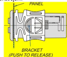
Pro zajištění krytí IP65 mezi čelním panelem přístroje a panelem rozvaděče použijte pryžové těsnění RG-C (objednává se zvlášť).
