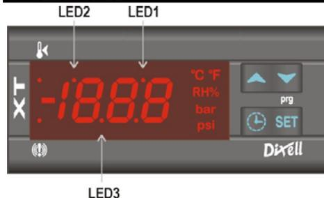
**SET:** k zobrazení a změně žádané hodnoty a v režimu programování k výběru parametru a potvrzení provedené operace.
