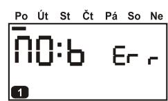
**MO:b ErP** Signalizuje správné připojení modulu, ale špatné nastavení Pln kódu! Je nutné odpojit modul, provést RESET termostatu a Pln kód nastavit správně! (Po 3 min. začne blikat na displeji termostatu nápis **Er:rP**).
