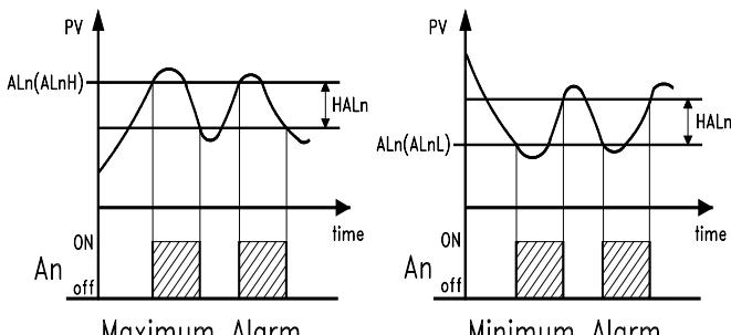
V případě poplachu typu okno se příklad spodního alarmu použije na spodní mez ("AL1L"), příklad horního alarmu je vhodný pro horní mez ("AL1H").
