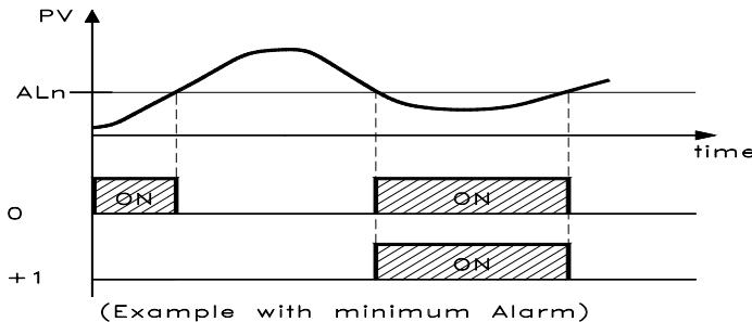
ZPOŽDĚNÍ ALARMU : alarmový výstup se může chovat dvěma různými způsoby, dle přiřčené hodnoty k par. "Ab1".
