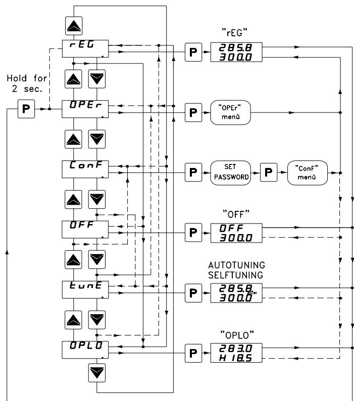
Pro výběr další skupiny parametrů podržte tlačítka "UP" nebo "DOWN" po dobu 2 sek., potom se zobrazení na displeji SV vrátí na kód vybrané skupiny parametrů. Uvolněte tlačítko a novou skupinu parametrů zvolte tlačítky "UP" a "DOWN".
