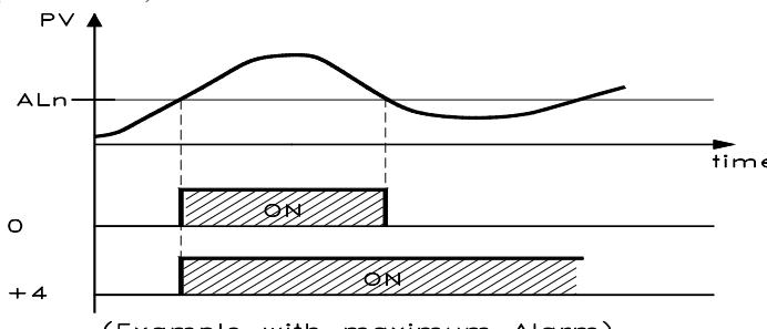
ZNALOST ALARMU : alarmový výstup se může chovat dvěma různými způsoby, dle přiřčené hodnoty k par. "Ab1".
