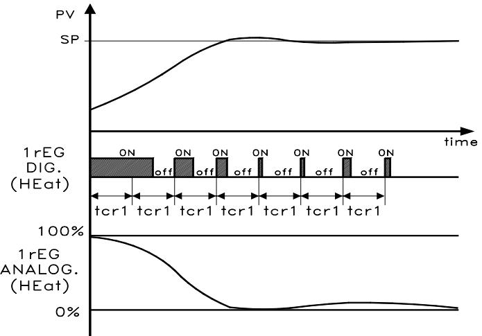
Proto je dosaženo velké stability regulované veličiny. V případě rychlých procesů musí být hodnota časového cyklu "tcr1" nižší než frekvence spinání regulovaného výstupu. Doporučuje se proto, pro toto řízení akčních členů, použít solid state relay (SSR).
