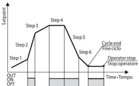
Lo stato di ON o OFF dell'uscita ausiliaria è selezionabile per ogni segmento (step) di ogni ciclo. Lo stato è impostabile anche a fine ciclo.
