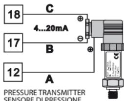
Per segnali normalizzati in corrente 0/4....20mA con sensore a tre fili
